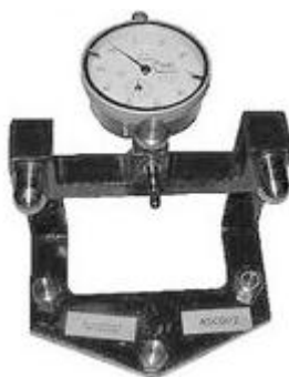
Rys. 6. Przyrząd do pomiaru płaskich miejsc
