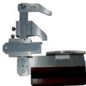
Rys. 5. Suwmiarka do pomiaru zarysu obręczy
